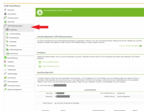
Auf der folgenden Seite bearbeiten Sie bitte den Anschluss (SIP-Trunk), an den Auerswald COMpact 4000 Telefonanlage angeschlossen werden soll.
